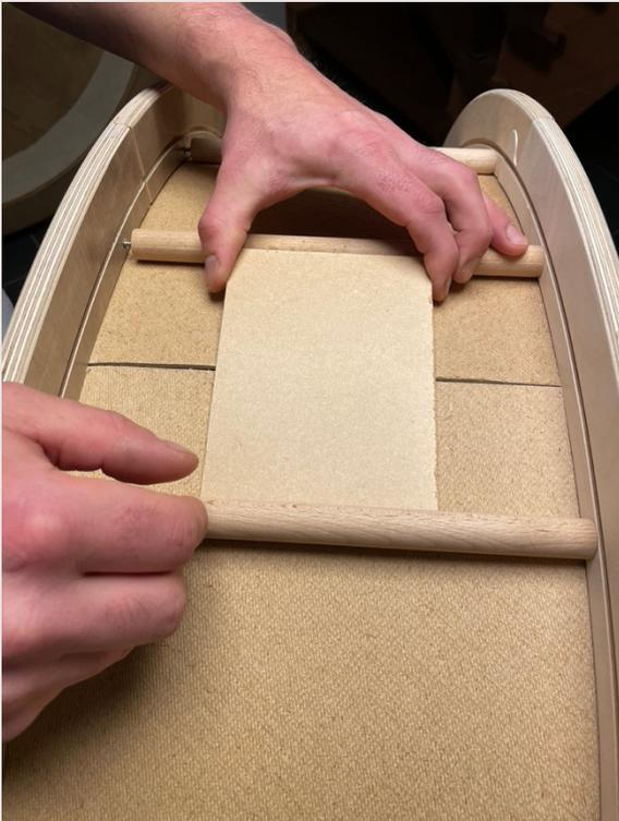
Platten an den Übergängen der Innenlauffläche von der Außenseite mittig unter die Rundstäbe schieben (5Stück).
