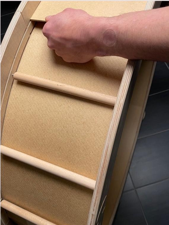
Für diesen Schritt empfiehlt es sich, mit dem Körper von hinten gegen den Innenkreis zu drücken und gleichzeitig mit der Hand die Platte in die gegenüberliegende Nut des Außenkreises zu führen.
