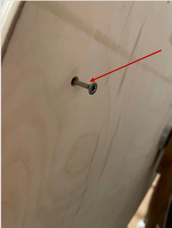
Die verwendeten M4x40 Torx-Schrauben nur soweit von hinten eindrehen, dass die glatte, gewindelose Fläche der Schraube noch zu sehen ist (dieser Abstand wird später zur Montage der Laufflächen benötigt).
