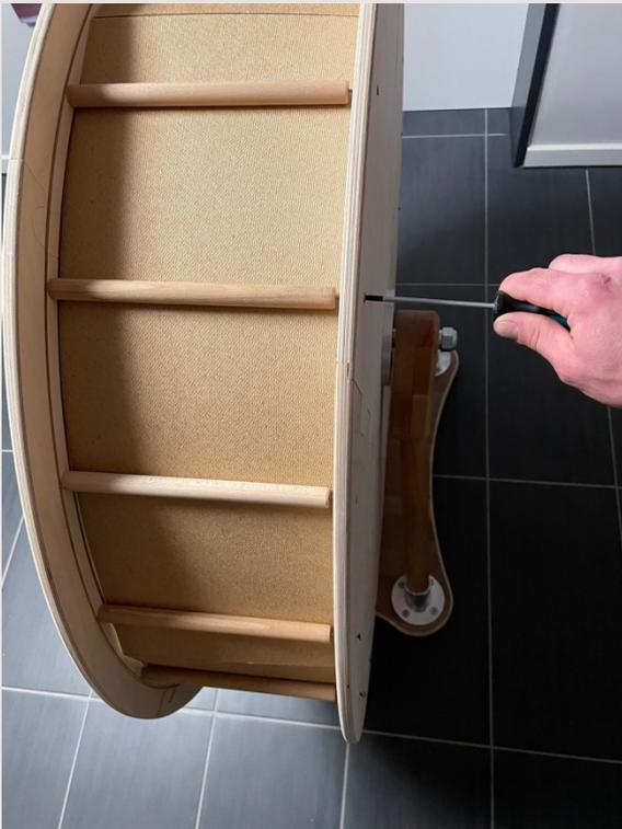
B: Wenn alle Platten in der Nut des Innenkreises stecken, werden die herausstehenden Schrauben nacheinander Stück für Stück eingedreht.
