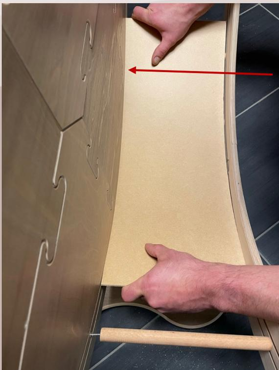
A: Jede Platte einzeln in die innere (tiefere) Nut des Innenkreises einstecken.
