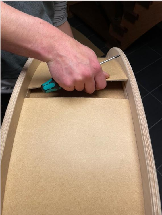
Platte für Platte einsetzen und spaltschließend an die bereits Eingefügten schieben (siehe nächstes Bild).
